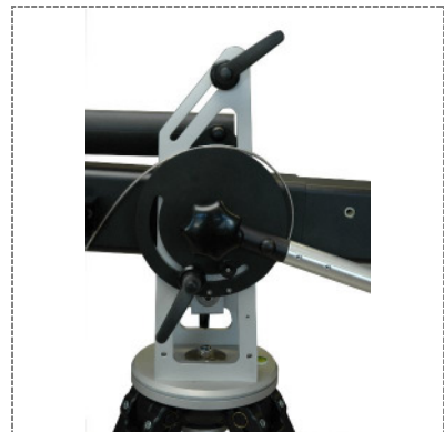
18. Steuerseil um Steuerscheibe legen / Wrap control cable around the disc
