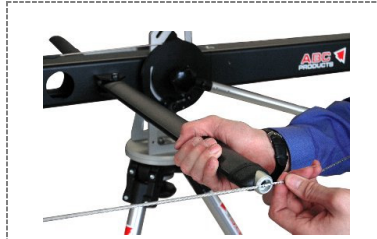
47. Klemmstück Seil mit Outrigger verbinden / Mount rope (clamping piece) with outrigger
