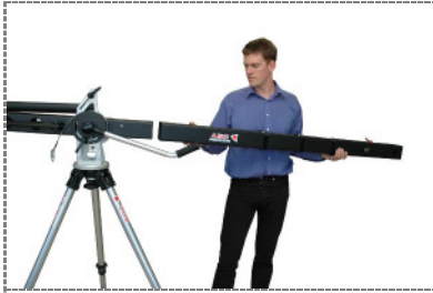
19. Segmente 3 und 4 (Endstück) miteinander verbinden / Connect segment no.3 with no.4
