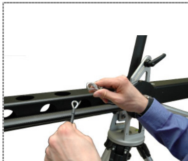
32. Turmseil sicher einhaken / Hook clamp securely
