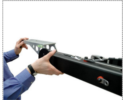
39. Kontrolle der Horizontposition des Krankkopfs / Check the position of crane head
