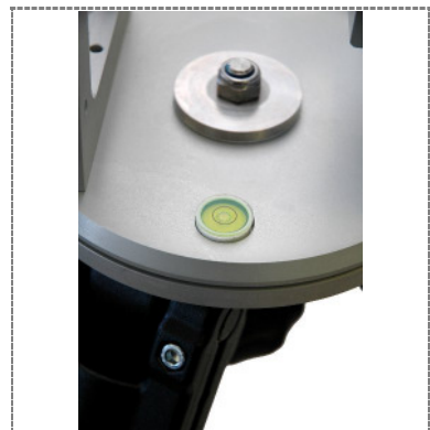
6. Stativ ausrichten – 0 Punkt/ Spirit level 0 point
