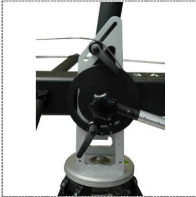
55. Umlenkrolle Steuerseil - Position: steile Krankopfwinkel / Deviation roller in lower position for steeper angle motion
