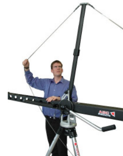
30. Turmrohr aufrichten / Erect tower tube
