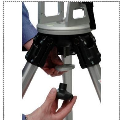
3. Sternschraube mit Beilagscheibe sicher befestigen / Fix screw with shim
