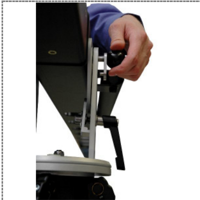
10. Rückseitig: Achsstift mit Pin in Buchse einführen / Fix axis pin in accurate position
