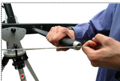
43. Klemmstück Abspannseil mit Outrigger verbinden / Connect rope (clamping piece) with outrigger
