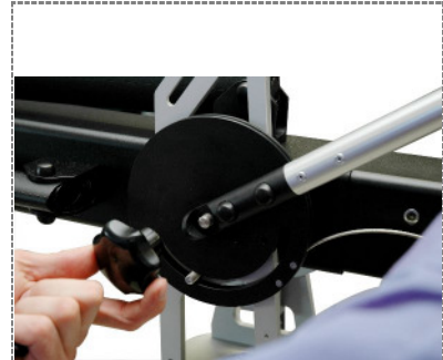
12. Sternschraube auf Achse schrauben / Fix lever with screw
