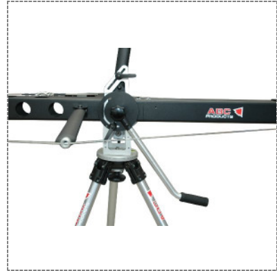
57. Krankopfwinkel mit Handbügel einstellen Achtung:, Fixierpin für Verstellung entfernen, Bremse öffnen, Winkel verstellen, Bremse schließen! / Adjustment of angle with lever: Remove the pin, open the brake. Change angle, fix the brake again!
