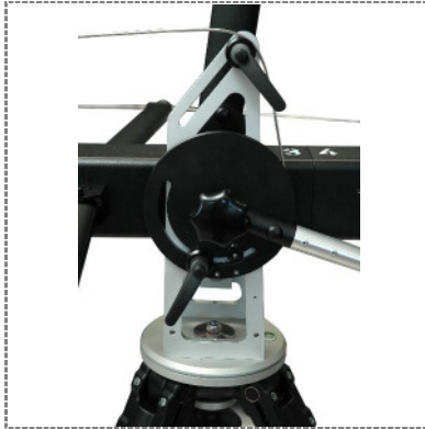
56. Umlenkrolle Steuerseil – Position sehr steile Krankopfwinkel / Deviation roller in position for extrem steeper angle motion
