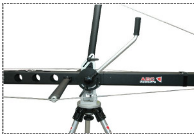
59. Krankopfwinkel mit Handbügel einstellen Achtung:, Fixierpin für Verstellung entfernen, Bremse öffnen, Winkel verstellen, Bremse schließen! / Adjustment of angle with lever: Remove the pin, open the brake. Change angle, fix the brake again!
