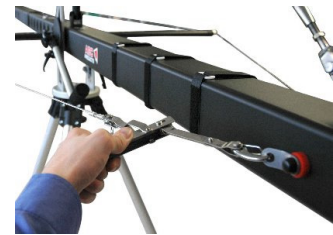
48. Spannschloss schließen / Close rod strainer of end segment no.4
