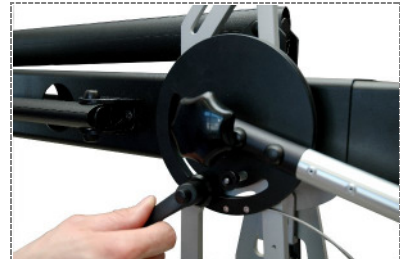
15. Fixierhebel für Krankkopfverstellung montieren / Mount lever for angle lever brake
