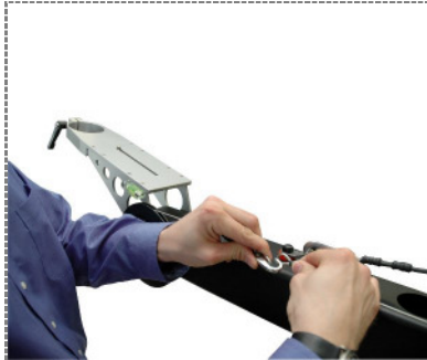
38. Steuerseil mit Krankopfseil verbinden /Connect steering rope with rope of crane head
