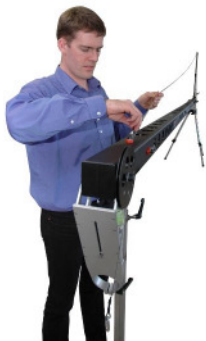
31. Turmseil zum Kopfsegment ● ziehen /Connect clamp with top segment
