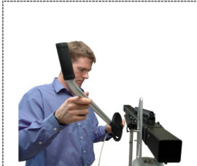
11. Verstellarm auf linker Seite der Stütze montieren / Mount lever on the left side of column
