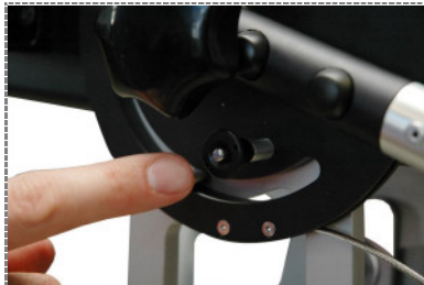
14. Druckpin in vorgesehene 0-Loch einführen (Krankkopf hält beim Schwenk Horizontposition (wichtig für Remote Head) / Stick pin in the recess for 0-Position
