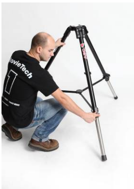
Bild 01 Stativ in gewünschter Höhe ausziehen, sicher aufstellen und nivellieren
