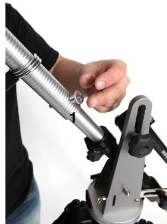
Bild 12 Endposition des Quickpins! Zum Lösen erneut den Endriegelungs- knopf (1) drücken!
