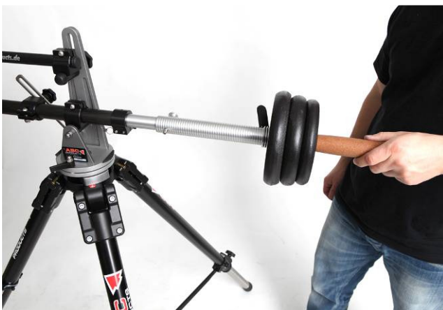
Bild 15 Richtige Montage der Rundgewichte!
