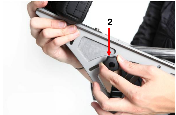
Bild 28 Jib-Kopf mit zweiter Hand stützen, Klemmschraube (2) öffnen und Winkel nach oben verstellen! Klemmschraube wieder sicher schließen!
