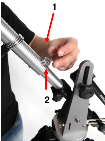
Bild 11 Hülse mit Riffelung über das Gegenge- wichtsrohr schieben! Bohrung (2) der Hülse muss mit Bohrung Gegengewichtsstange übereinstimmen! Für die Montage wird der Quickpin (1) benötigt! Knopf für das Durchschieben des Quickpins drücken!
