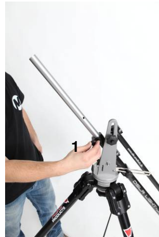
Bild 10 Gegengewichtsrohr ca. 40cm ausziehen. Klemmschraube (1) wieder sicher schließen.
